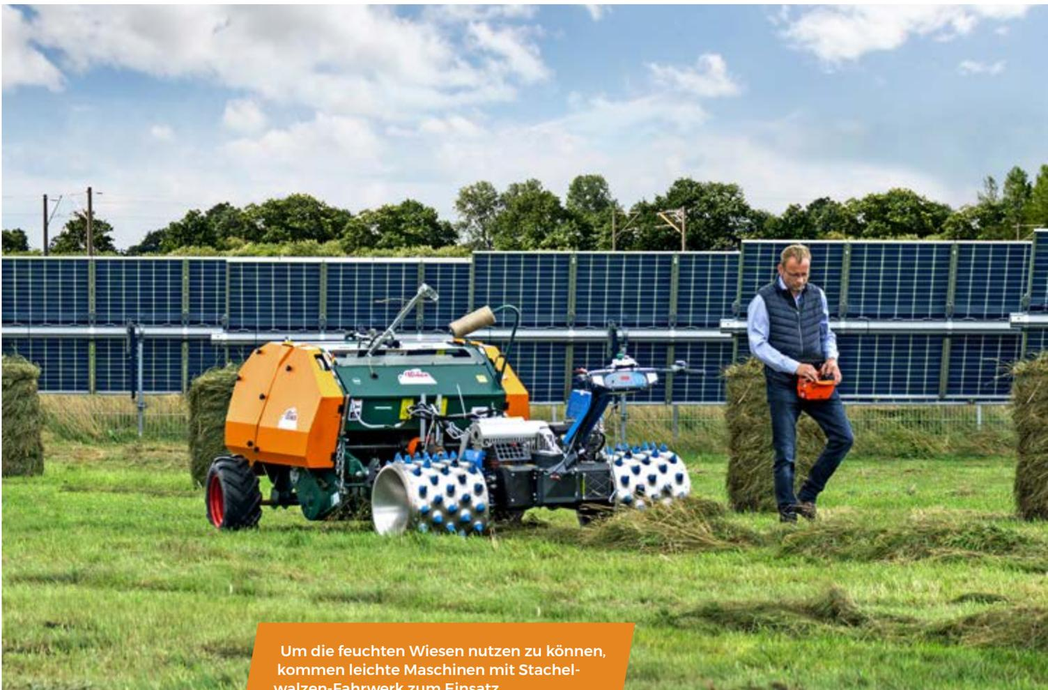
Um die feuchten Wiesen nutzen zu können, kommen leichte Maschinen mit Stachelwalzen-Fahrwerk zum Einsatz.
